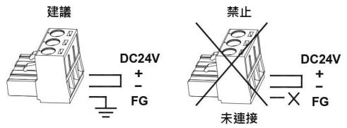
此產品和其他設備應具有相同的電氣接地(參考電壓電平),否則可能發生通信錯誤。
