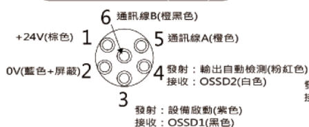
M8連結器母座腳位 (電氣端)
